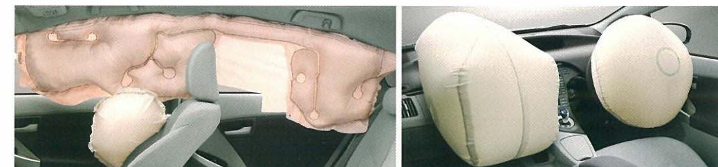
\*4.SRS[乗員保護補助装置]:Supplemental Restraint System ■SRSエアバッグは、あくまでシートベルトを補助する装置です。必ずシートベルトをご着用ください。■すべてのSRSエアバッグは、衝突の条件によっては作動しない場合があります。 ■写真は機能説明のために各々のSRSエアバッグが作動した状態を再現したものです。 ■SRSサイドエアバッグ、SRSカーテンシールドエアバッグは、実際の衝突時には衝突側のみ膨らみます。 ■チャイルドシートなどを助手席に装着する時は、後ろ向きにしないなど、ご注意いただきたい項目があります。必ず取扱書をご覧ください。
