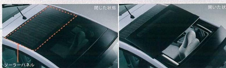
【ソーラーベンチレーションシステム＆リモートエアコンシステムとソーラーパネル付ムーンルーフはGにセットでメーカーオプション、Sにスマートエントリー（運転席・助手席・
