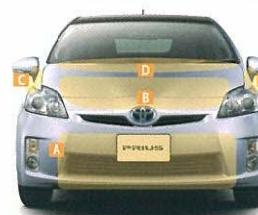
A 衝撃吸収バンパー構造 C 衝撃吸収フェンダーブラケット構造
